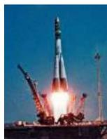
На орбиту же вылетела капсула, по форме напоминающая пушечное ядро, с третьей ступенью двигателя. Общая масса космического корабля достигала 4,73 тонны, длина (без антенн) — 4,4 м, а диаметр — 2,43 м. Вес космического корабля вместе с последней ступенью ракеты-носителя составлял 6,17 тонны, а их длина в связке — 7,35 м
